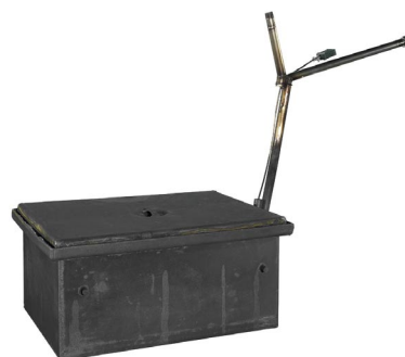
Härdbox utrustad med gasanslutning och extra termoelement.
